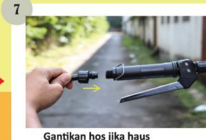
7 Gantikan hos jika haus Replace the hose if it worn out
