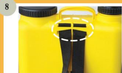
8 Periksa tali dan ganti jika perlu Check and replace straps if necessary
